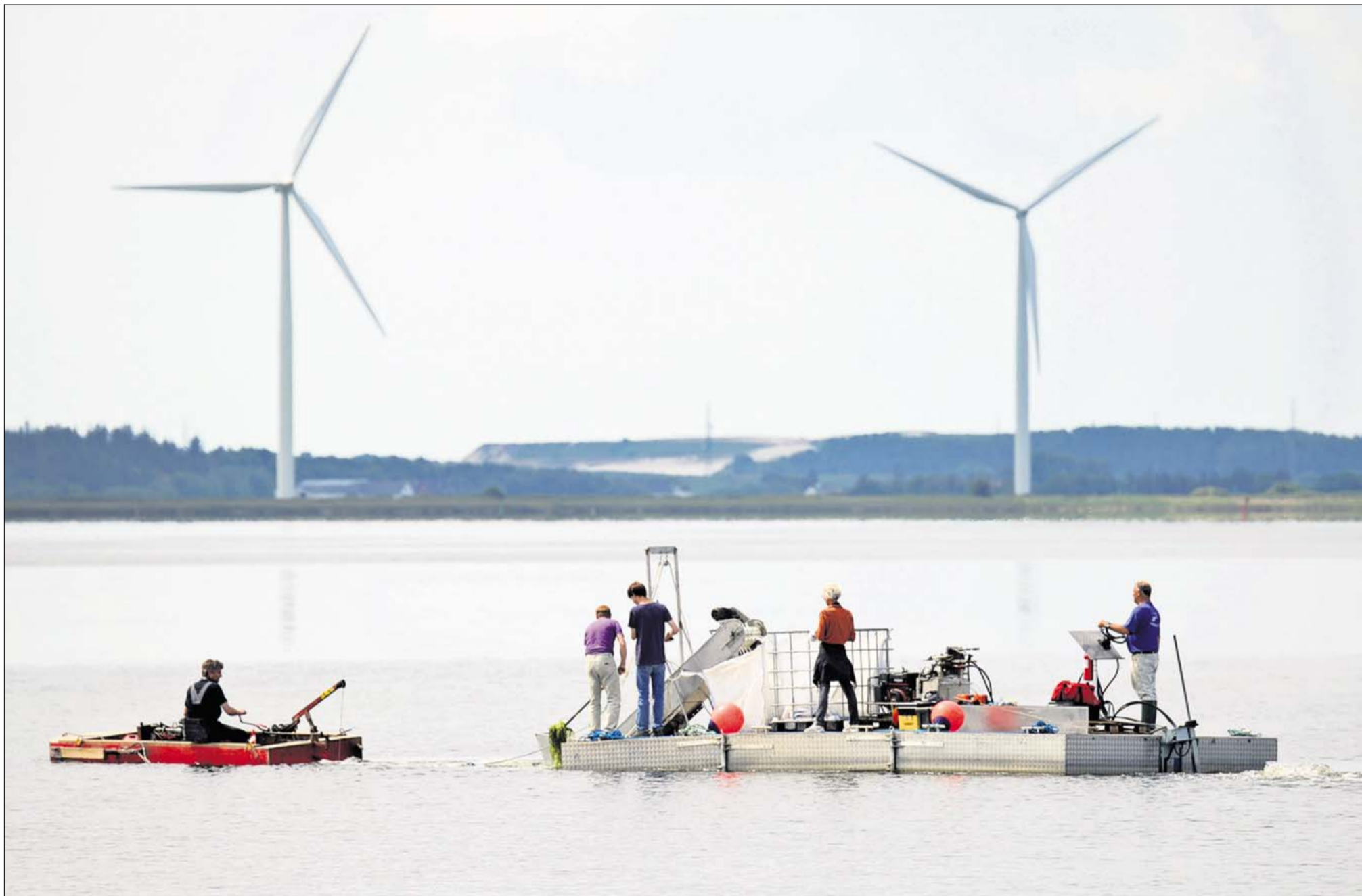
En grødeskærer laver forarbejdet på fjorden, og den flade høstmaskine fra firmaet Multidyk samler ålegræsset op. Øvelsen handler om at raffinere teknikken, så man kan høste og skaffe frø fra ålegræs i stor stil. Fotos: Jan Skriver
